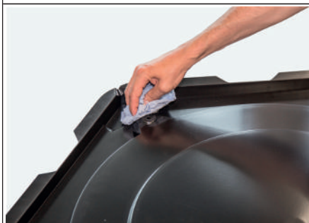
Ill. : 35: Nettoyer le collecteur d'eau de condensation
